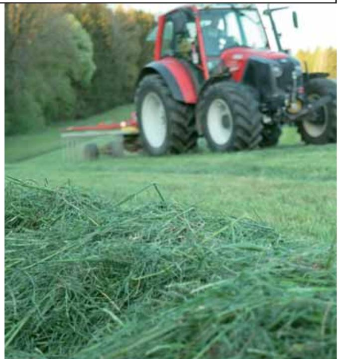
Bei optimaler Arbeitshöheneinstellung kann der Kreiselzettwender eine vorhandene erdige Futtermverschmutzung sogar reduzieren, weil bei der Zettarbeit die schwere Erde schneller auf den Boden fällt als das Futter. Dieser positive Effekt kommt bei der Heuwerbung stärker zur Geltung als bei der Silage.
