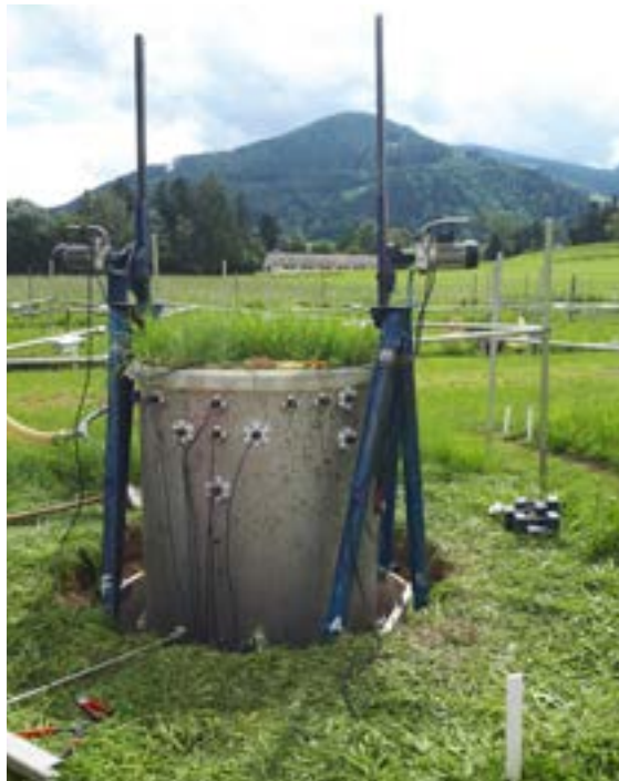
Abbildung: Lysimeter zur Ermittlung von Bodenwasserhaushaltsgrößen, HBLFA
